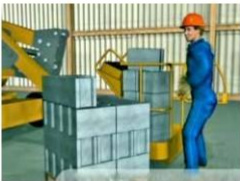
Figura 41. Plataforma de trabajo sobrecargada.
