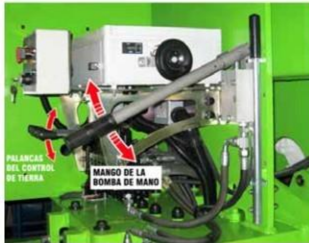
Figura 36. Dispositivo manual de bajada de emergencia en la base de la PEMP.
