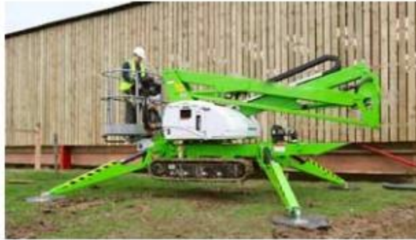
Figura 39. Estabilizadores hidráulicos con placa de apoyo.
