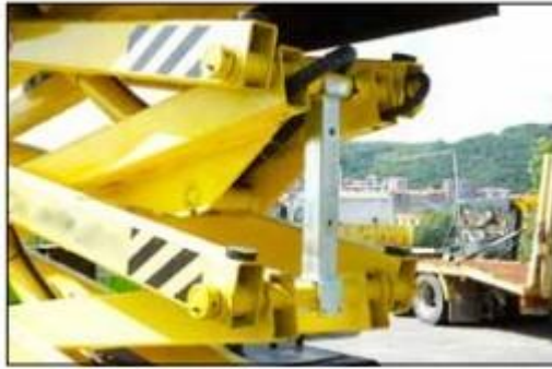
Figura 40. Sistema mecánico de seguridad. Detalle.
