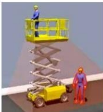
Figura 46. Control de presencia de operarios en proximidad.
