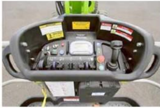
Figura 34. Mando primario sobre plataforma de trabajo.
