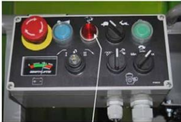
Figura 37. Indicador de alarma de señalización de inclinación máxima.
