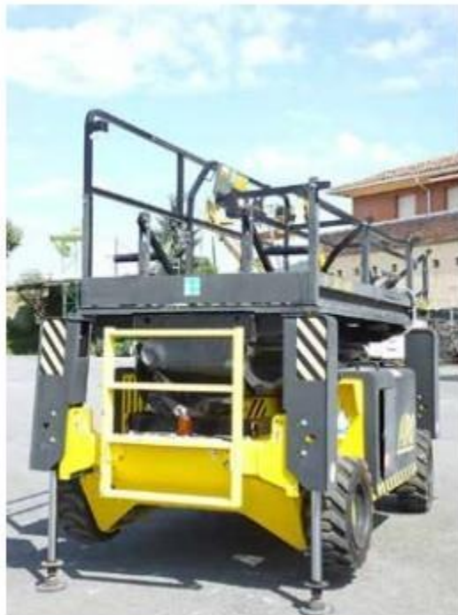
Figura 30. Plataforma de trabajo con protecciones perimetrales plegables.
