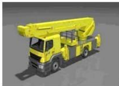
Figura 4. PEMP sobre camión
