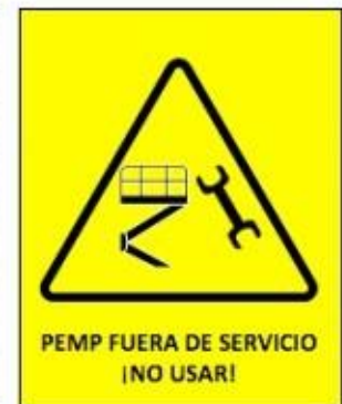
Figura 48. Señal de PEMP fuera de servicio.
