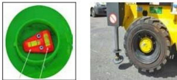
Figura 25. Nivel de burbuja longitudinal y transversal del chasis y figura 26. Base de apoyo de un estabilizador
