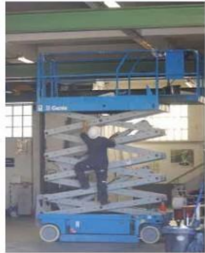
Figura 11. Subir/bajar, a/desde la plataforma de trabajo por la estructura extensible
