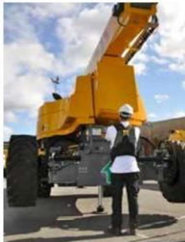
Figura 38. Elevación del chasis para la extensión del área de estabilidad.
