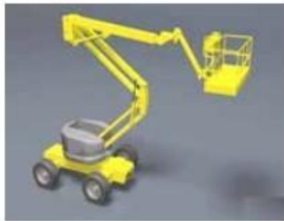
Figura 6. PEMP de estructura articulada
