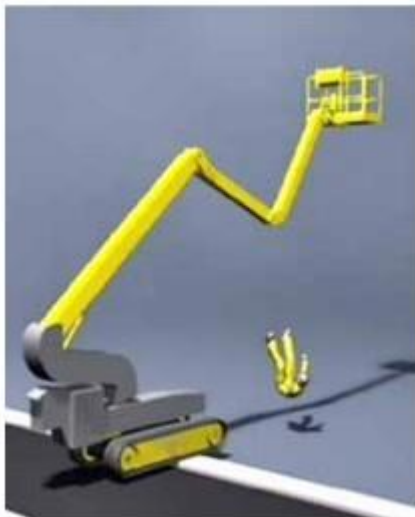
Figura 12. Caída por efecto catapulta
