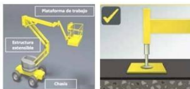
Figura 2. Partes principales de una plataforma elevadora móvil de personal y Figura 3. Placas estabilizadoras
