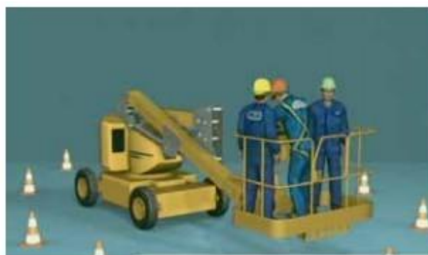
Figura 18. Plataforma de trabajo con exceso de personas
